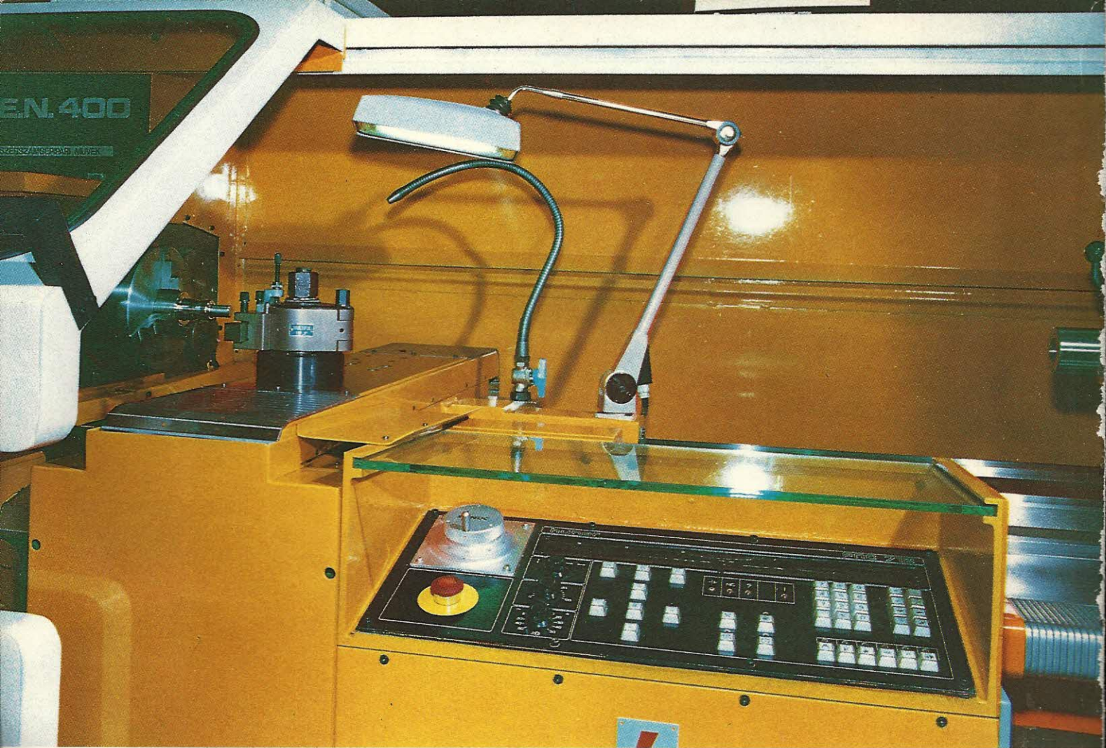
Beépített esztergagépvezérlés • Built-in lathe control system • Eingebaute Drehmaschinensteuerung • Встроенное устройство управления токарными станками
