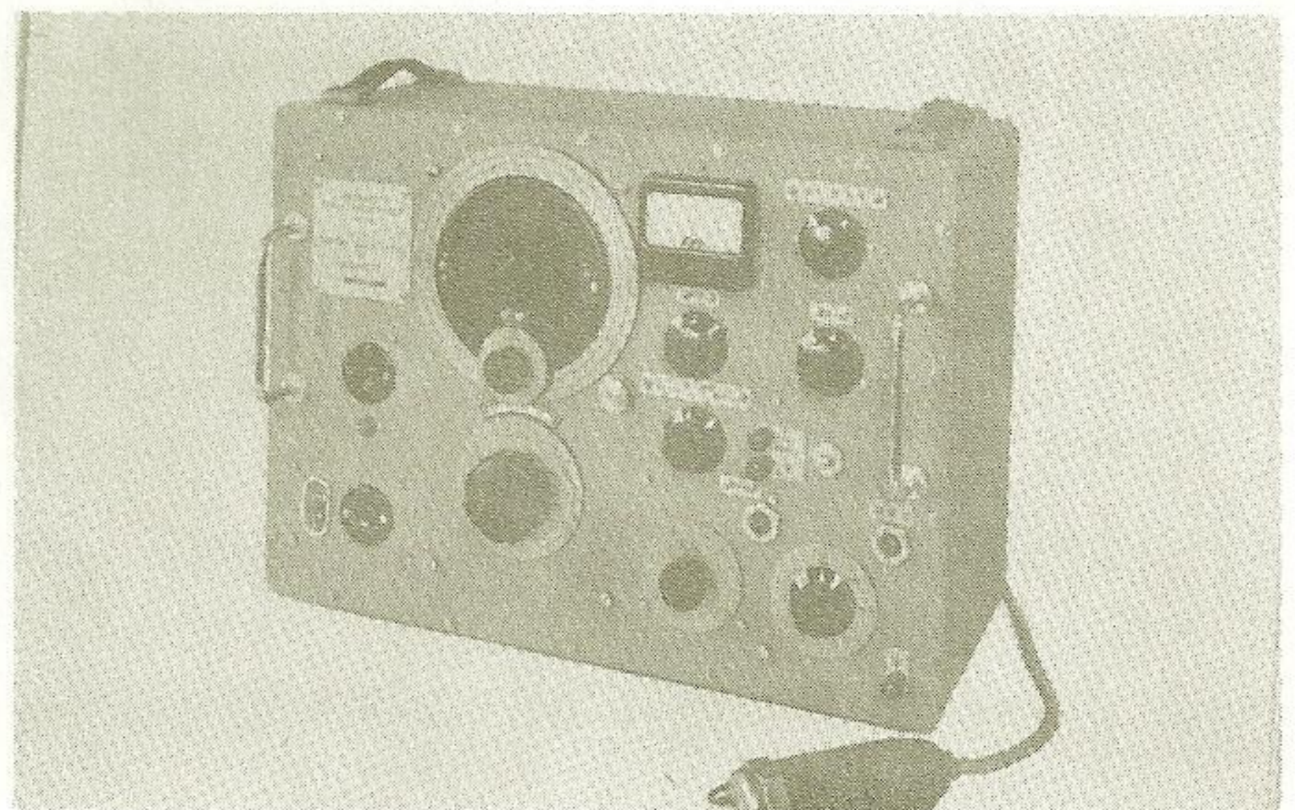
Laboratóriumi szignálgenerátor, Type SP 60822
